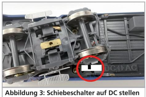
Abbildung 3: Schiebeschalter auf DC stellen
