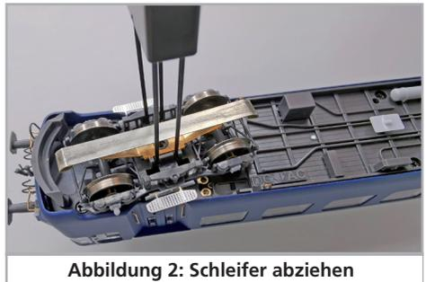
Abbildung 2: Schleifer abziehen
