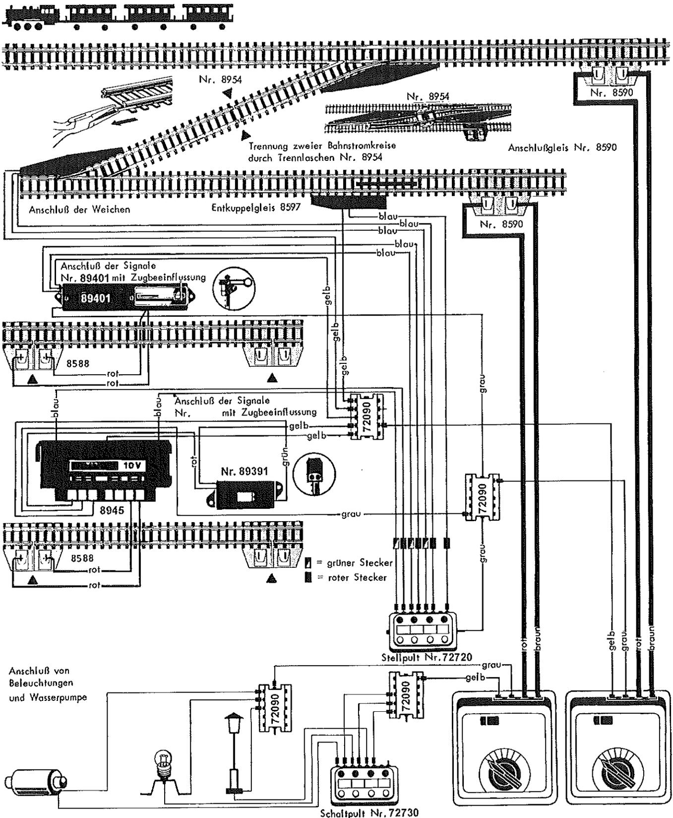
Die Trenngleisstücke 8588 müssen so eingebaut sein, daß die unterbrochene Schiene auf der Seite liegt, an der das rote Kabel am Anschlußgleisstück 8590 angeschlossen ist.
